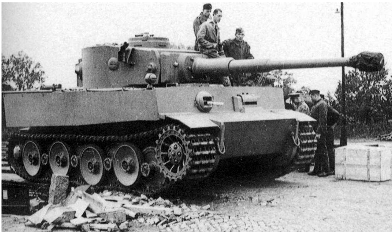
«Тигр» с транспортными гусеницами, прибывший в расположение 501-го тяжелого танкового батальона в Ордрюфе. Август 1942 года.
