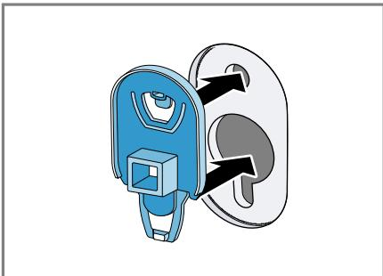
6. Зафиксируйте 4 пластиковые накладки нажатием вниз.
