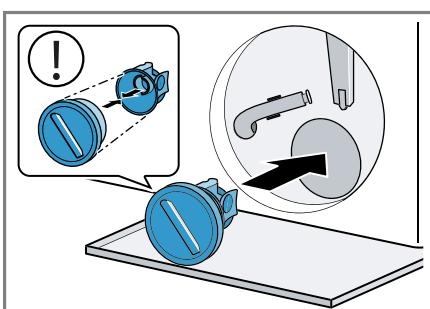
**4. Закрутите крышку насоса до упора.**
