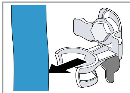
2. Выверните ① и снимите ② винты всех 4 транспортировочных креплений при помощи гаечного ключа SW13.
