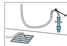
Зафиксируйте и закрепите сливной шланг скобой.
