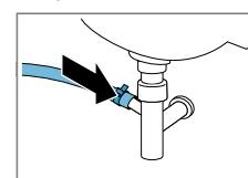
Зафиксируйте соединение хомутом (24-40 мм).
