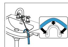
Зафиксируйте и закрепите сливной шланг скобой.
