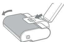
2. Извлеките валик. Для этого нажмите на подшипник сбоку напольной щетки и толкните его вверх. Затем вытащите валик, как показано на рисунке.
