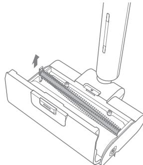
4. Очистите посадочные места турбощетки и валика. Удалите волосы, шерсть, пыль и прочие загрязнения.
