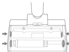
5. Очистите турбощетку и срежьте намотанные шерсть и волосы. Вы можете использовать канцелярский нож для удаления волос. На турбощетке есть специальный паз, проведите по нему кончиком канцелярского ножа, все волосы срежутся, затем снимите оставшиеся волосы руками. Очистите ось турбощетки от загрязнений и намотанных волос. Допускается мыть турбощетку под проточной водой.
