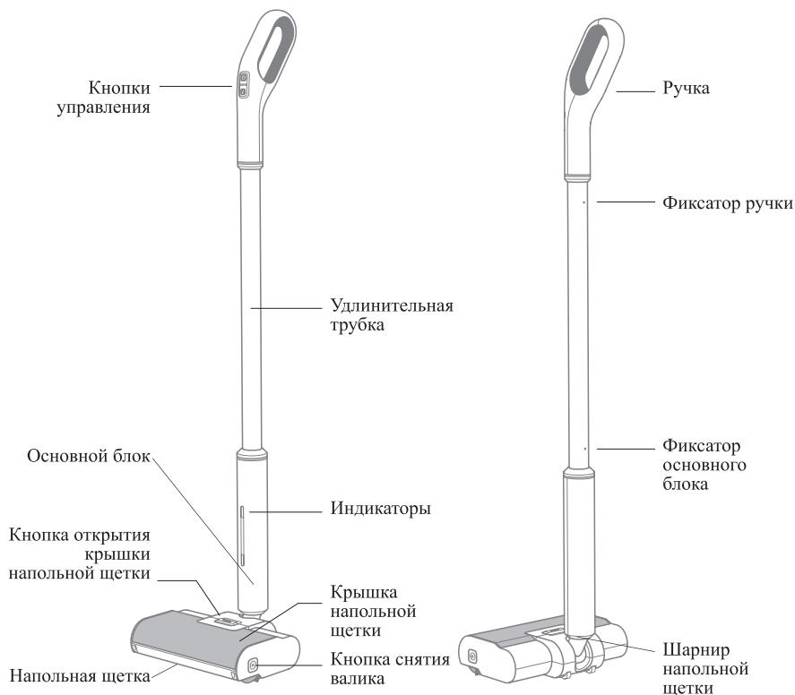
Беспроводная электрошвабра состоит из напольной щетки, удлинительной трубы и ручки. Уборка электрошваброй осуществляется примерно так же, как обычной шваброй, за исключением того, что вам не нужно отжимать тряпку, а также электрошвабра не оставляет влажный мусор и пыль, прилипшие к полу. Благодаря инновационной конструкции напольной щетки с пола удаляется абсолютно весь мусор: как сухой, так и влажный. Очистка швабры после уборки осуществляется автоматически одним нажатием кнопки.
