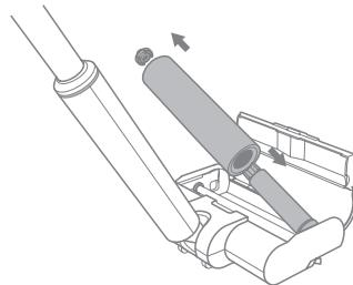
3. Извлеките турбощетку. Для этого потяните ее вверх с левой стороны, чтобы фиксатор вышел из паза.
