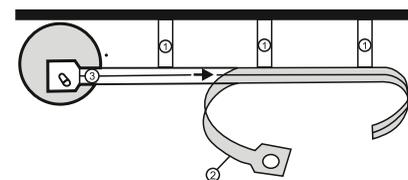
Пригладьте радиоприемный элемент к стеклу, используя для этого подходящий предмет, например, стеклоочиститель.
