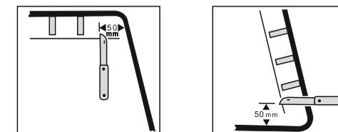
Закрепите радиоприемные элементы. Положите дополнительные прозрачные кружки на кончик стеклоочистителя и приклейте их к началу и к концу радиоприемных элементов, затем осторожно пригладьте. Снимите ограничительные полоски.
