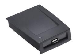
Базовая модель предназначена для работы со смарт-картами (Mifare), модель -D предназначена для работы с бесконтактными картами (EM-Marin)
