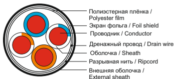
Рисунок 2 – Конструкция кабеля типа F/UTP (количество жил 2×2) / Figure 2 – Cable design of F/UTP type (number of cores 2×2)
