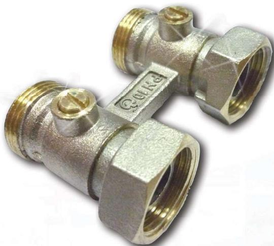
Кран применяется в качестве запорного устройства для нижнего подключения радиатора отопления. Кран может быть использован как в однотрубной, так и в двухтрубной системе отопления и позволяет отключить радиатор для его демонтажа или технического обслуживания без слива теплоносителя из всей системы отопления.
