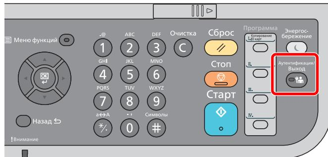
Для окончания сеанса работы на аппарате нажмите клавишу **[Аутентификация/Выход]**, чтобы отобразить экран ввода имени пользователя для входа/пароля.
