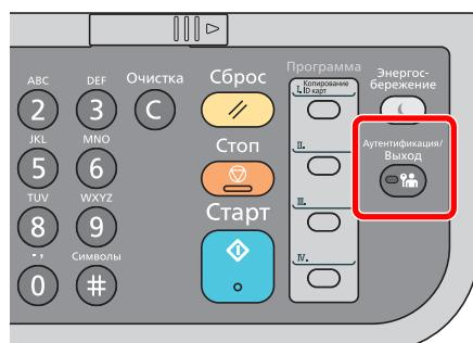
Для окончания сеанса работы на аппарате нажмите клавишу **[Аутентификация/Выход]**, чтобы отобразить экран ввода имени пользователя для входа/пароля.
