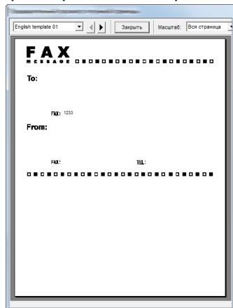
Чтобы отобразить другой шаблон, воспользуйтесь раскрывающимся меню вверху диалогового окна или нажмите кнопку [ $\blacktriangleleft$ ] или [ $\triangleright$ ]. С помощью раскрывающегося меню можно также изменить коэффициент масштабирования отображения шаблона в диапазоне от 25 до 250%.
