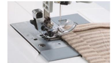
Обеспечивает необходимое положение прижимной лапки для обработки узлов с изменяемой толщиной, например в начале шва или при пересечении швов.
