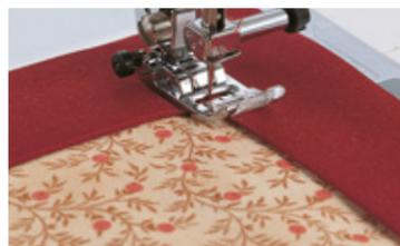
Не требуется поворачивать маховик машины, чтобы опустить иглу. При обработке углов выберите функцию «останов иглы в нижнем положении» и поверните ткань необходимым образом, а при обработке прямых швов выберите функцию «останов иглы в верхнем положении».\*
