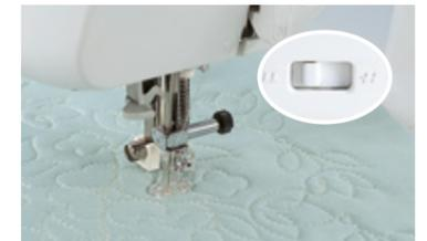
Рычаг опускания рейки используется при необходимости для свободной подачи ткани, при стегальных работах, вышивке и выстрачивании монограмм.
