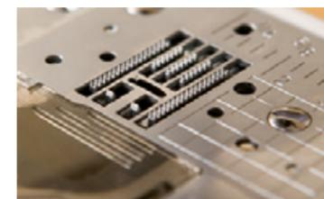
Дополнительный сегмент транспортера обеспечивает равномерное продвижение ткани. Гарантирует великолепное качество каждого стежка и гладкие аккуратные швы на ткани любой толщины от тонкого шелка до вельвета и толстой джинсы.
