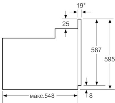
\* При металлической фронтальной панели 20 мм
