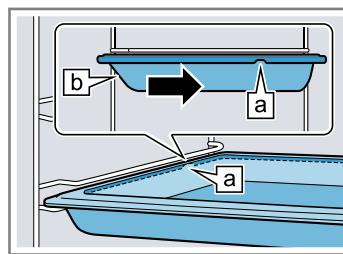
3. Полностью задвиньте принадлежности так, чтобы они не касались дверцы прибора.
