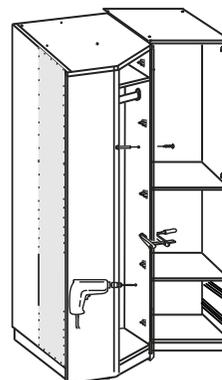
При установке нескольких модулей, рекомендуется скрепить их между собой стяжными винтами
