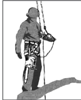
Рис. 15 Пример крепления пилы к ремню оператора
