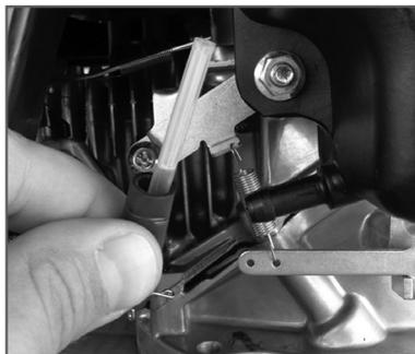
Рис. 16 Топливный фильтр
