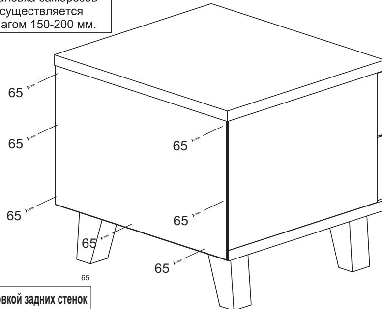
Перед установкой задних стенок выровнять диагональ корпуса.
