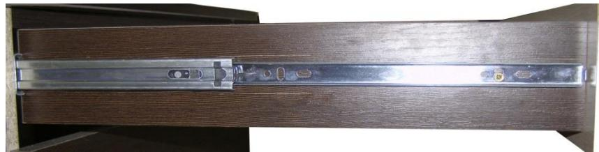
Вследствие чего внутри направляющей покажутся стопоры позволяющие вынуть направляющие до конца, для дальнейшего использования крепления направляющей к стойке ящика.
