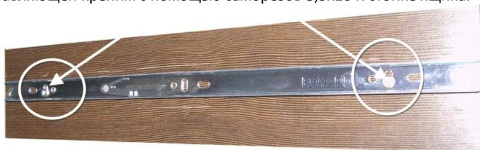
Оставшуюся часть направляющей крепим с помощью саморезов 3,5x16 к стойке стола.
