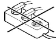
➤ Прибор следует подключать только к электрической розетке, защищенной плавким предохранителем и заземленной в соответствии с установленными нормами.
