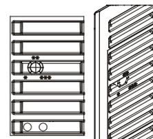
➡ Для установки температуры поверните регулятор на нужное значение (от \* до \*\*\*) с помощью отвертки с плоским шлицем.
