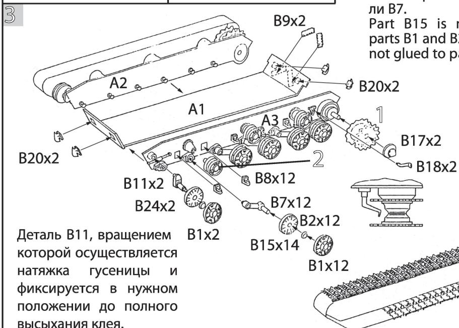
Деталь B15 не приклеивается к деталям B1 и B2. Деталь B2 не приклеивается к детали B7.
