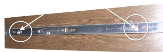
3) Оставшуюся часть направляющей крепим с помощью саморезов 3,5x16 к стойке шкафа.
