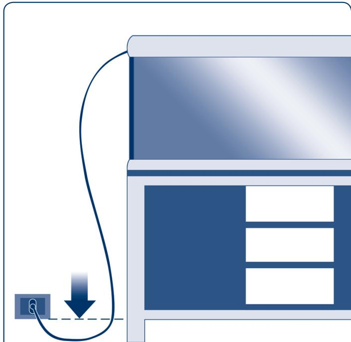
Brancher les fiches au secteur en réalisant une boucle avec le câble, plus basse par rapport à la prise, afin d'éviter que d'éventuelles gouttes d'eau atteignent le réseau électrique.
