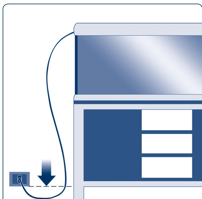
Die Stecker an das Stromnetz anschließen und hierbei eine Kabelschleife bilden, die tiefer als der Stecker zu legen ist, um zu vermeiden, dass Wasser auf das Stromnetz tropft.
