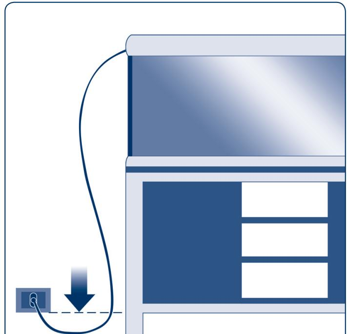
Zapojte zástrčku do zdroje napájení a pod zásuvkou nechejte smyčku na kabelu, aby se předešlo stékání vody do zdroje napájení.
