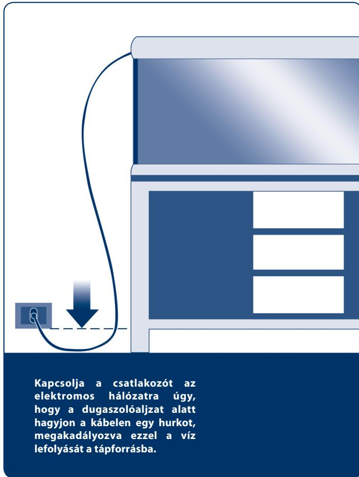
Kapcsolja a csatlakozót az elektromos hálózatra úgy, hogy a dugaszolóaljzat alatt hagyjon a kábelben egy hurkot, megakadályozva ezzel a víz lefolyását a tápforrásba.
