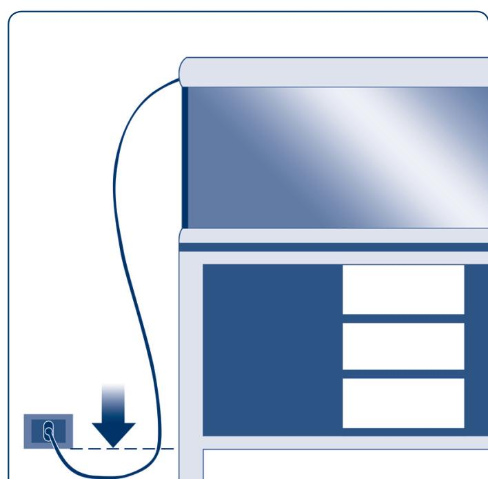
Conecte los enchufes a la red y deje un asa en el cable, un poco más abajo de la toma, para evitar que alguna gota de agua pueda alcanzar la red de alimentación.
