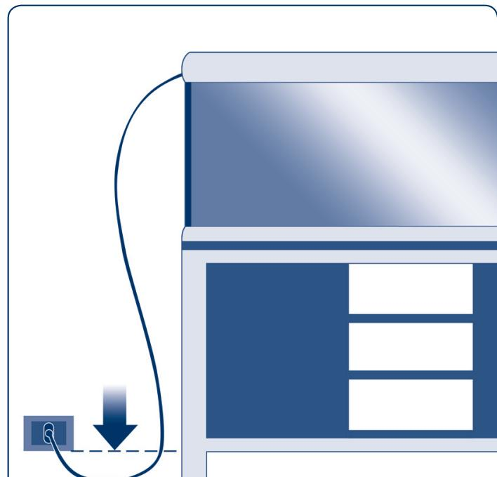
Kabel zasilający podłącz tak aby najwyższy punkt przewodu elektrycznego znajdował się poniżej gniazdka elektrycznego – zapobiegnie to przypadkowemu ściekaniu wody po przewodzie do gniazdka.
