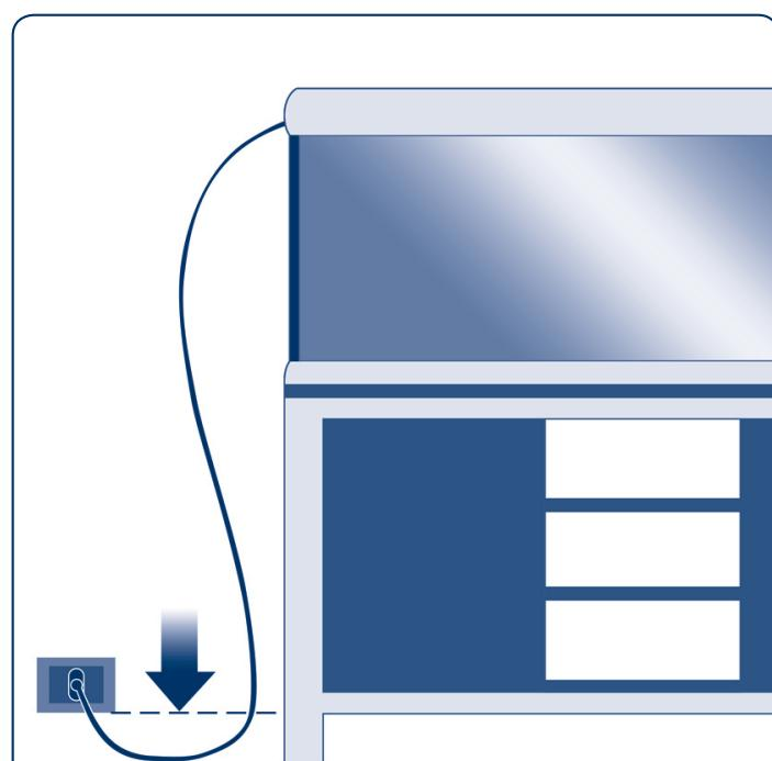
Steek de stekker in het stopcontact met een lus in het snoer die onder het stopcontact moet liggen zodat er geen waterdruppels in het contact kunnen komen.
