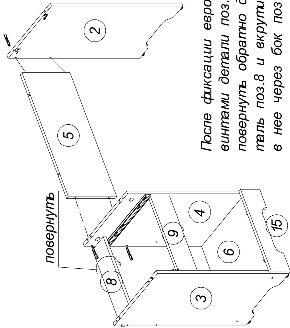
После фиксации евро-винтами детали поз.5 повернуть обратно деталь поз.8 и вкрутить в нее через бок поз.3 евровинт.
