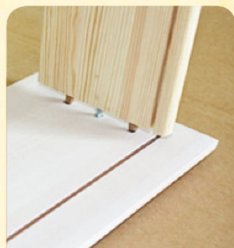
23. Соединить фасад с ящиком
