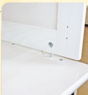
6. Установить бока большие на средний горизонт
