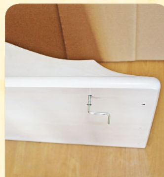
13. Соединить комфирматом корону с верхним горизонтом
