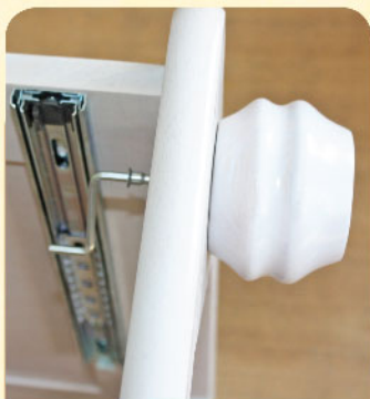
2. Соединить комфирматом опоры к нижнему горизонту
