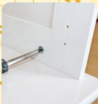
7. Зафиксировать бока эксцентриком
