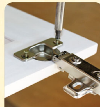
17. Зафиксировать петли саморезом 4x16 к фасадам шкафа
