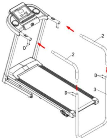
После того, как все винты будут вкручены, с помощью инструмента затяните установленные винты и вставьте ключ в предохранитель.
