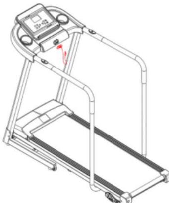
**Складывание тренажера:** Когда тренажер не планируется использовать в течение длительного времени, вы можете его сложить. Вытащите штифт #50, возьмитесь за заднюю часть бегового полотна рукой, медленно поднимайте полотно до тех пор, пока гидравлический цилиндр не издаст щелчок. Затем вставьте штифт № 50 в указанное положение.
