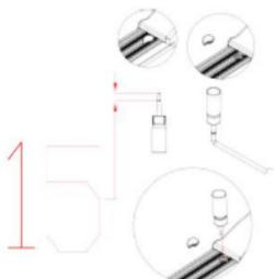
Подготовьте пипетку со смазкой к использованию, откройте левую подножку сзади декоративной накладки, с помощью ножниц или канцелярского ножа проделайте небольшое отверстие в пипетке маслёнки, чтобы дозаправить смазку как показано на рисунке. Обратите внимание на емкость с маслом перед тонким стержнем, вставленным в магистраль на платформе, а затем залейте туда смазку.
