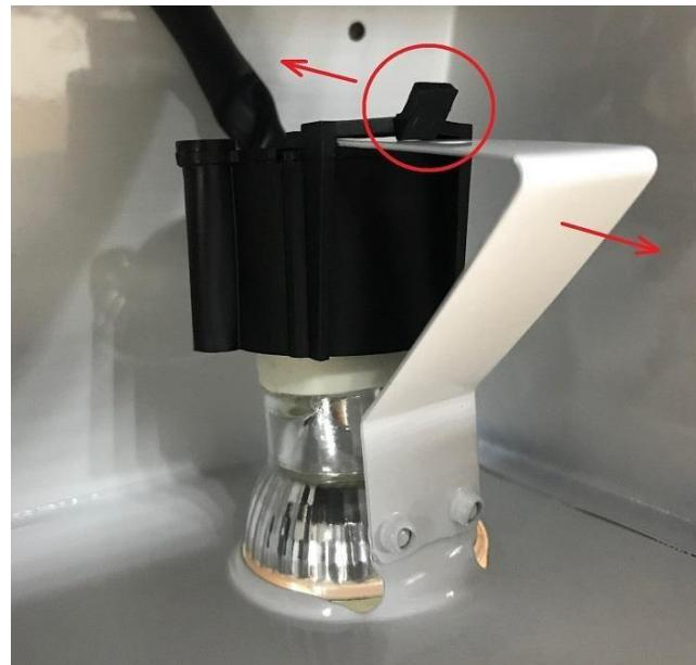
придерживайте патрон 11), другой прижмите снизу и поверните ее  $45^{\circ}$  против часовой
