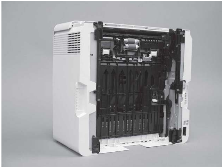
Рисунок 9-18 Поместите принтер нижней стороной вперед
