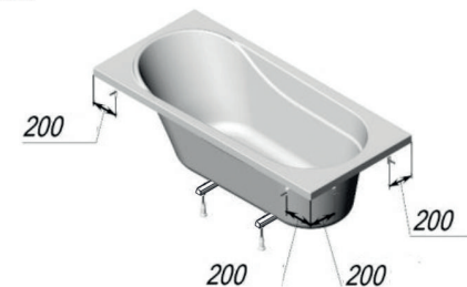
Рисунок 6 – крепление ванны к стене
