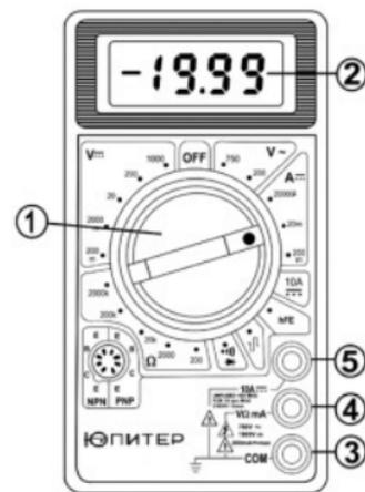
1. Поворотный переключатель диапазонов используется для выбора функции и предела измерения. Для выключения прибора указатель на переключателе необходимо установить в положение «OFF».
