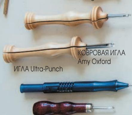
**Ковровые иглы и крючки** | Бывают разных форм и размеров. Выбор инструмента зависит от веса используемой пряжи.
