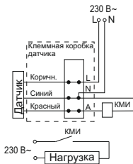
Рисунок 5 – Схема подключения датчиков с контактором КМИ
