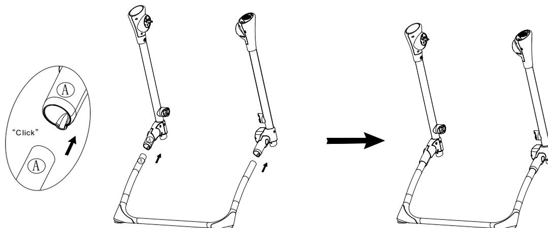
2. Вставьте до щелчка заднюю опору в соответствующие отверстия в нижней части стоек: В в В (см. рисунок ниже).
