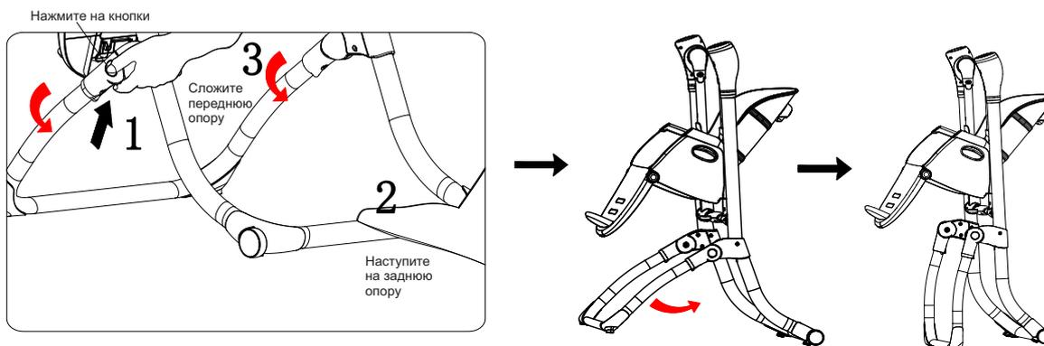
15. Чтобы разложить стульчик, нажмите на кнопки слева и справа, наступите на заднюю опору и разложите переднюю опору — см. рисунок ниже.
