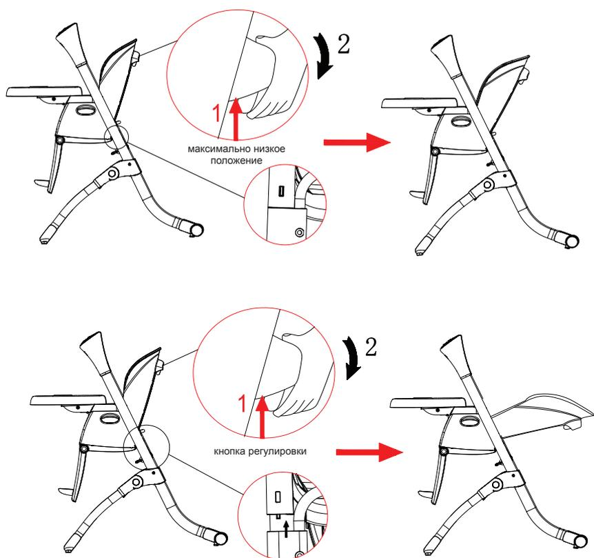
5. Нажмите кнопки регулировки с обеих сторон, как показано на рисунке выше. В изделии предусмотрено 6 уровней высоты. При регулировке высоты возьмитесь руками за сиденье с обеих сторон и равномерно приподнимите его, пока не услышите щелчок.
