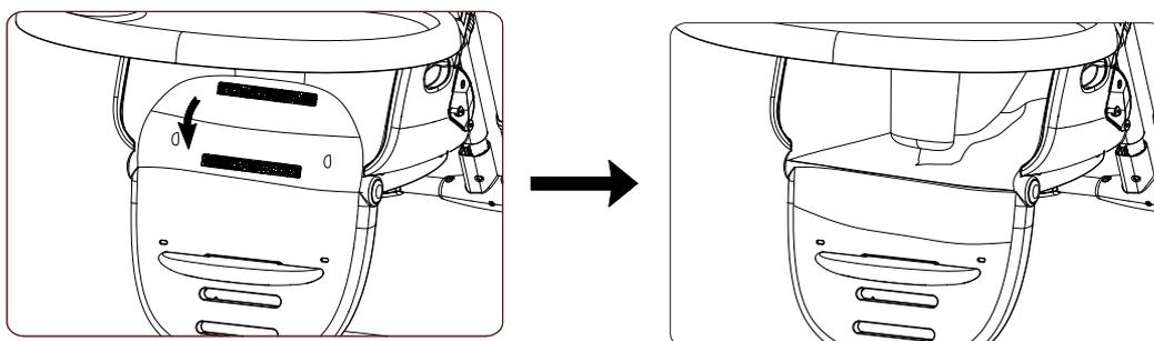
14. Чтобы сложить стульчик, нажмите на кнопки слева и справа, наступите на заднюю опору и сложите переднюю опору — см. рисунок ниже.
