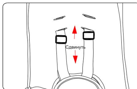
12. Когда подставка для ног находится в горизонтальном положении, снимите прикрепленную к ней эластичную ленту, сложите подставку и зафиксируйте ее при помощи застежек-липучек. Надевая поверх подставки чехол, проденьте эластичную ленту сквозь подставку и закрепите эластичную ленту на педали — см. рисунок ниже.
