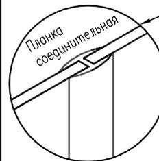
Ориентация стяжки C5 – показана на рис, после сборки с дюбелем В4 стяжку затянуть по стрелке
