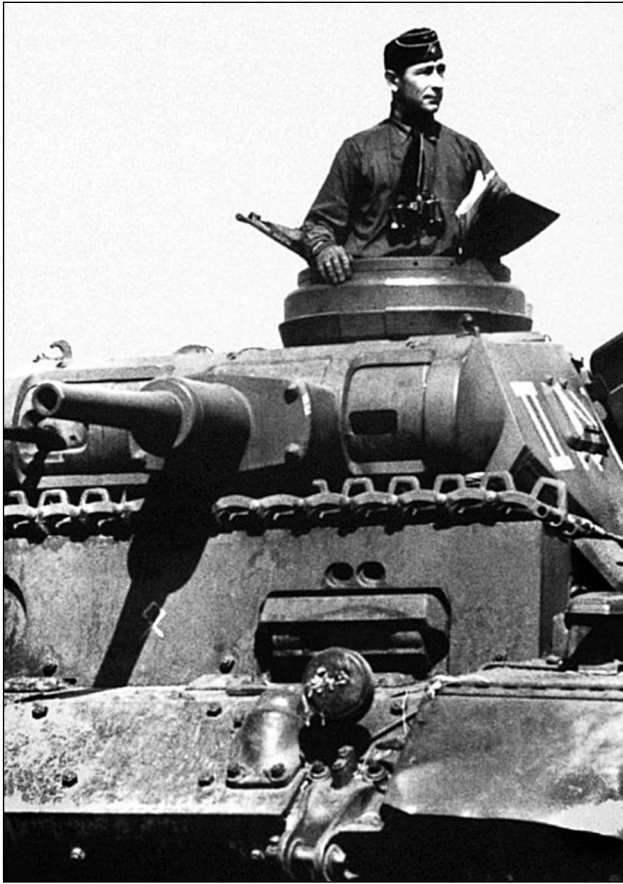
Командирский танк 14-й танковой дивизии. Установка пулемета в лобовом листе корпуса заделана заглушкой. Такие машины несли дополнительный комплект радиоборудования
