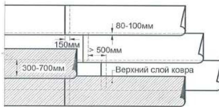
Рисунок 7 – Схема смещения полотнищ кровельных рулонных материалов в смежных слоях
