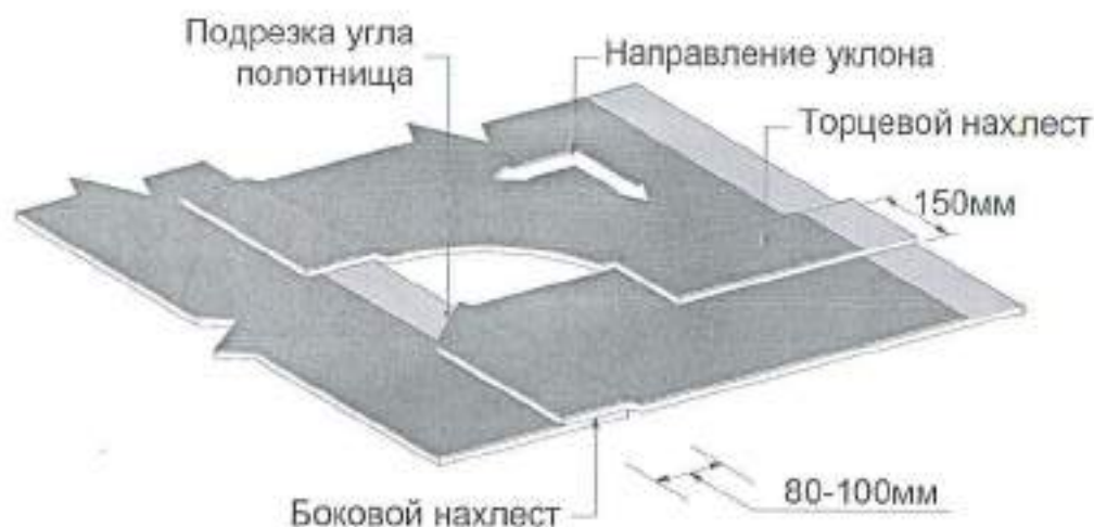
Рисунок 6 – Размеры нахлестов полотнищ кровельных рулонных материалов
