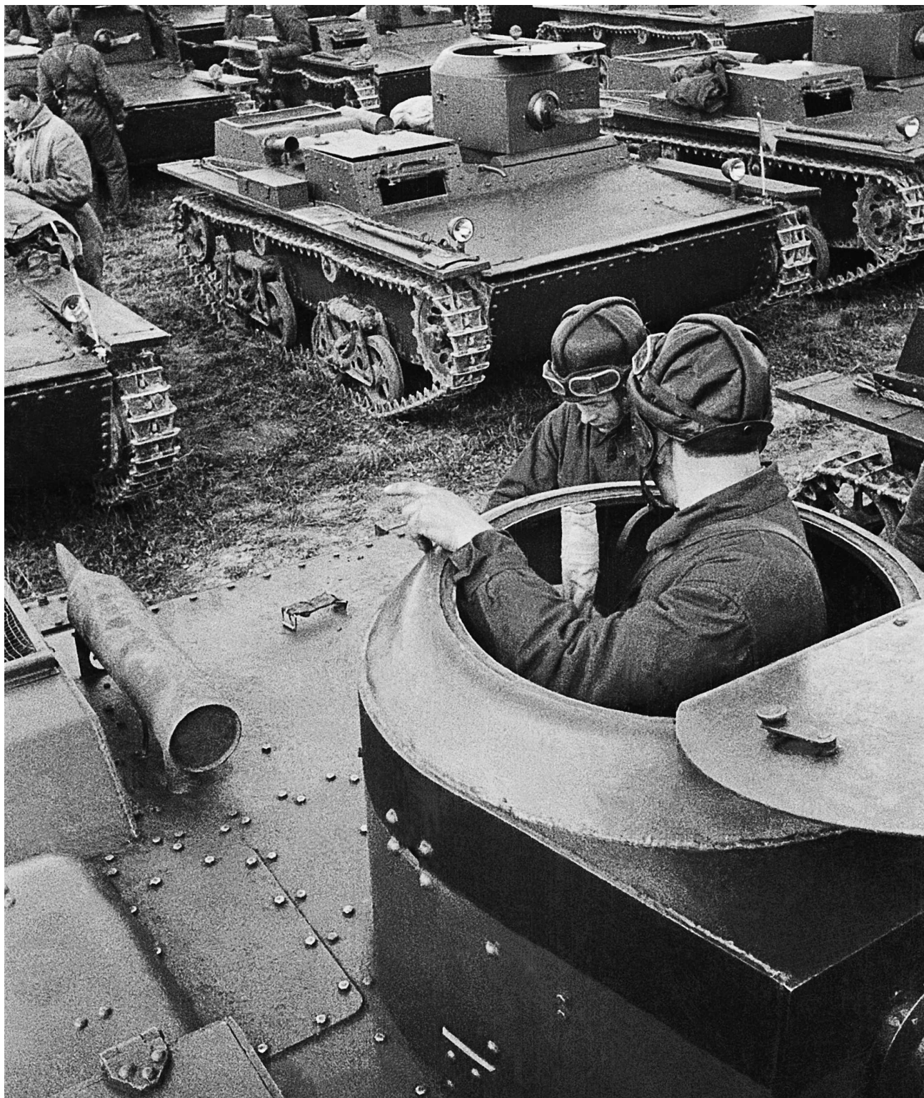
Танки Т-38 перед началом учений. Московский военный округ, лето 1936 года. Верхняя часть башни передней машины окрашена в красный цвет, хорошо видна установка глушителя, а также фрагмент люка механика-водителя и колпака над отверстием для забора охлаждающего воздуха к двигателю (ЦМВС)
