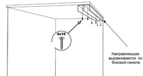
Нижняя направляющая сдвинута относительно верхней направляющей в глубину шкафа на 16мм
