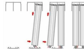
Заводим верх двери в нужный паз верхней направляющей до предела и устанавливаем колесами роликов в паз нижней направляющей, опустив дверь. С каждой стороны двери в нижнем отверстии находится регулировочный винт, при помощи шестигранного ключа на 4мм необходимо при необходимости выровнять двери по высоте, добиваясь плотного прилегания профилей ручек к боковым стенкам шкафа.
