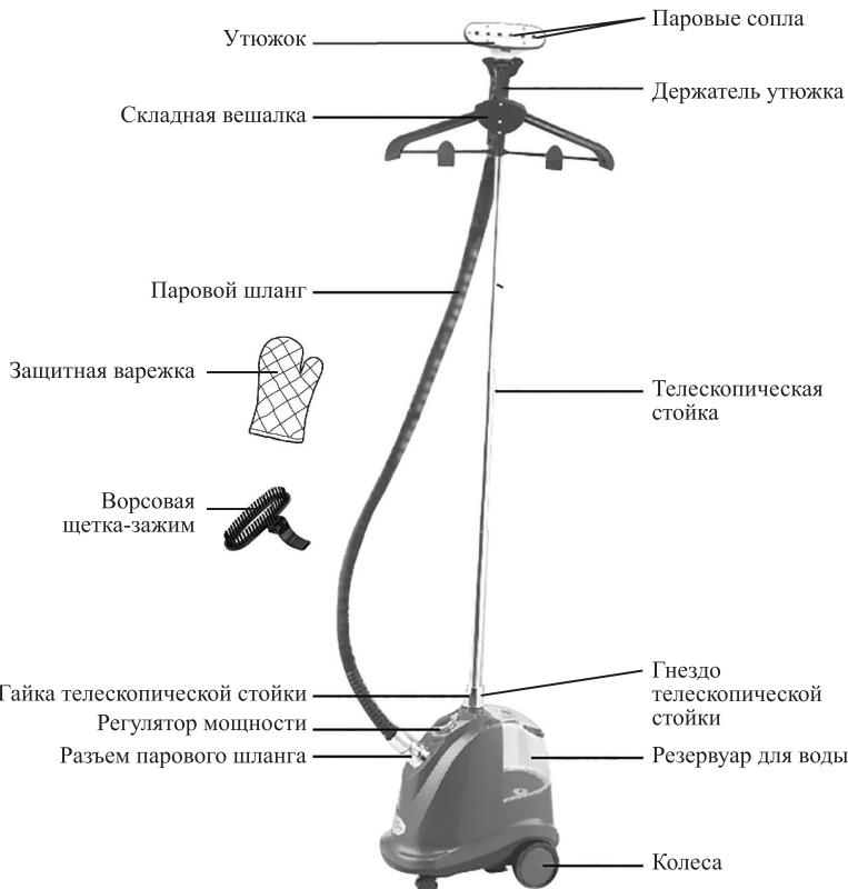
Резервуар для воды позволяет легко залить воду. Под резервуаром располагается ванночка, из которой вода перетекает в бойлер. В комплекте есть держатель утюжка и складная вешалка. Корпус отпаривателя имеет напольное исполнение и оснащен колесами для удобного перемещения.
