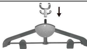
5. Установите вешалку с держателем утюжка на телескопическую стойку. Просто наденьте ее на телескопическую стойку до упора
