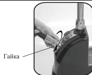
**Примечание.** Не переносите отпариватель за телескопическую стойку. Корпус отпаривателя тяжелый, особенно с полным резервуаром, крепление стойки может не выдержать и отпариватель упадет.
