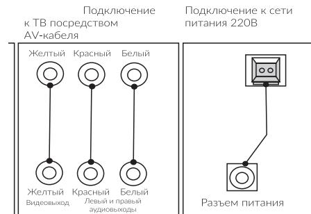
Консоль оснащена AV-кабелем с выходом Audio-Video для подключения консоли к телевизорам и мониторам, оснащенных AV-выходом. Подключите кабель AV через вход (2) к приставке, а затем подключите кабель к соответствующим выходам на телевизоре или мониторе, следуя указанной схеме.
