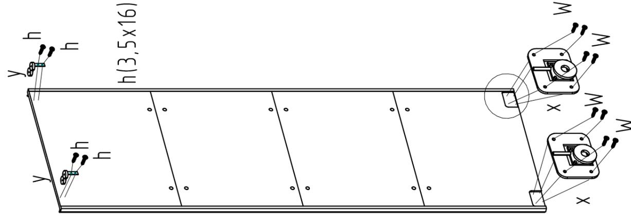
К фасаду прикрутить ролики X саморезом 3,5x12 (W)
