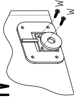
после регулировки фасада закрутить два самореза 3,5x12
