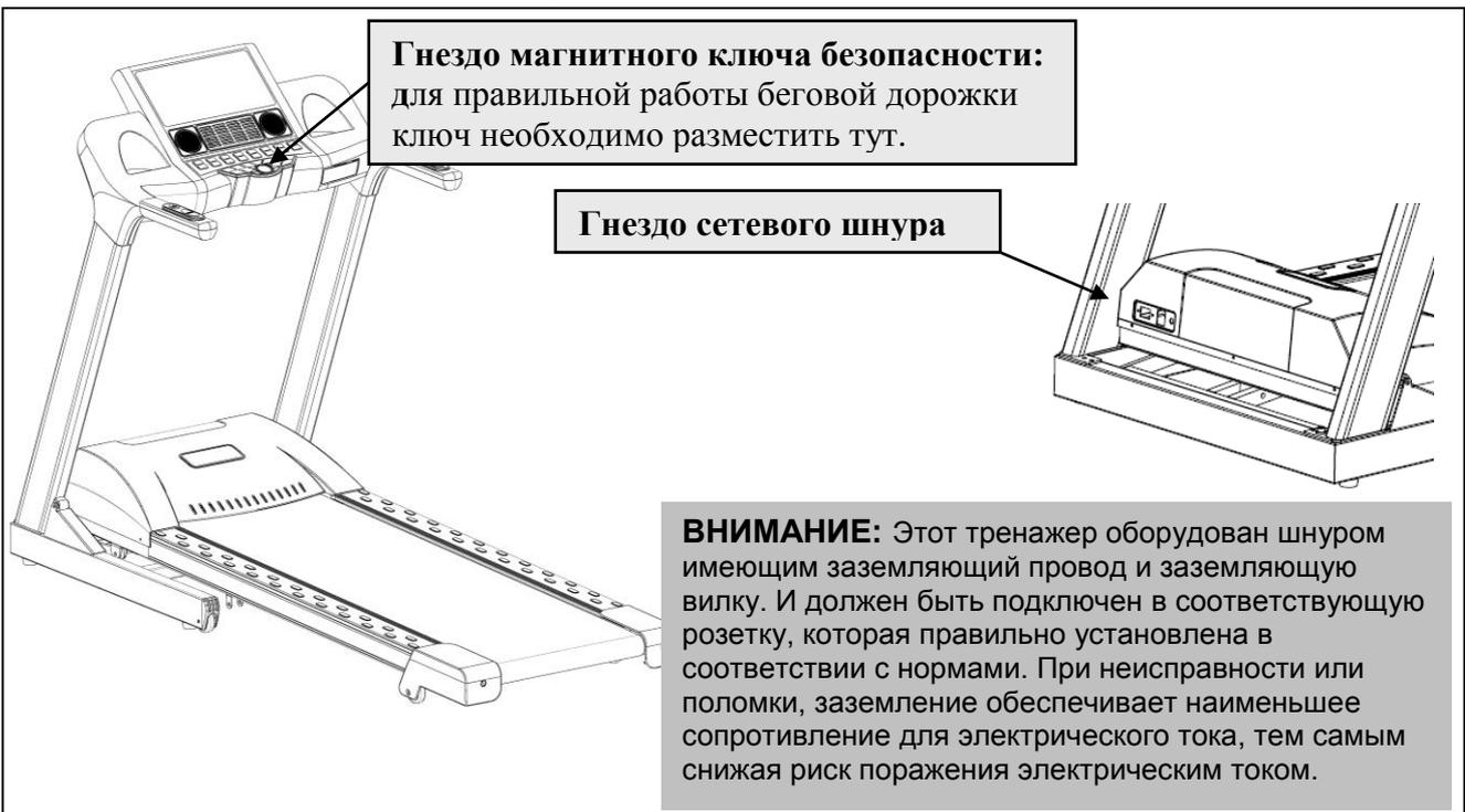
**ВНИМАНИЕ:** Этот тренажер оборудован шнуром имеющим заземляющий провод и заземляющую вилку. И должен быть подключен в соответствующую розетку, которая правильно установлена в соответствии с нормами. При неисправности или поломки, заземление обеспечивает наименьшее сопротивление для электрического тока, тем самым снижая риск поражения электрическим током.
