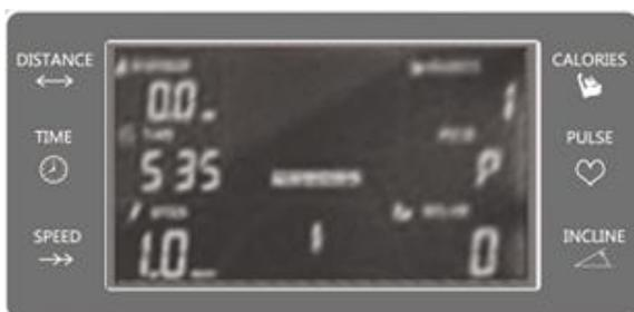
1. «Скорость»: на дисплее в разделе «SPEED» отображается текущая скорость движения бегового полотна в настоящий момент. Возможные значения от 1.0 до 18 км/ч.
