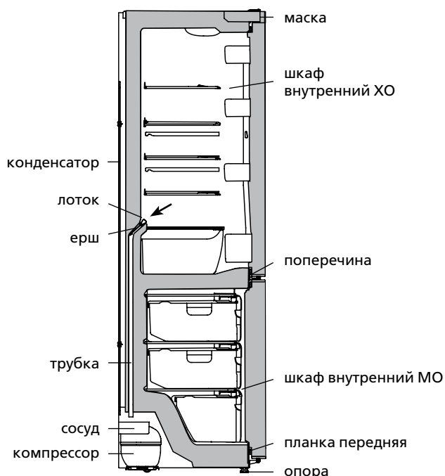
Рисунок 6 – Схема слива талой воды из ХО
