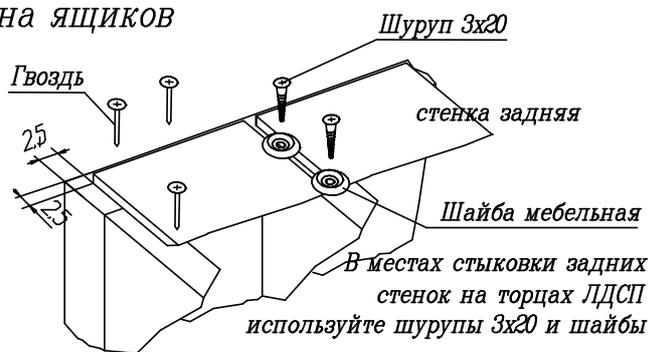
Начните сборку каркаса. Проверьте перпендикулярность и параллельность щитов и зафиксируйте с помощью задней стенки из ДВП, как указано на рисунке, не нарушая диагонали.
