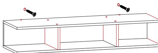
Закрепите шуруп с прессшайбой к стене, навесьте на шурупы полку.
