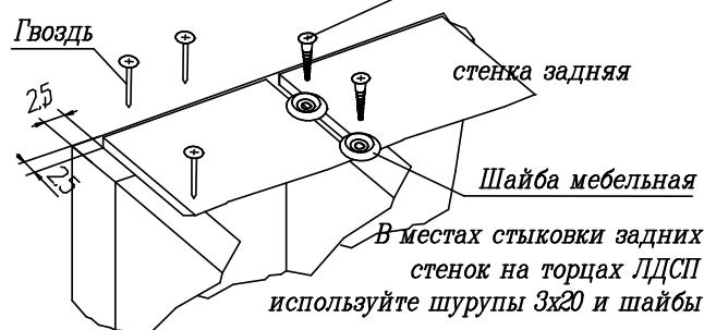
Начните сборку каркаса. Проверьте перпендикулярность и параллельность щитов и зафиксируйте с помощью задней стенки из ДВП, как указано на рисунке, не нарушая диагонали. Помните, что от этого зависит правильность работы выдвижных ящиков и створок.
