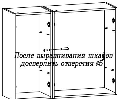
Во избежание опрокидывания шкафа, зафиксируйте его с рядом стоящими шкафами, просверлив самостоятельно отверстия Ø5 мм в стенках вертикальных и скрепив их между собой стяжкой межсекционной.
