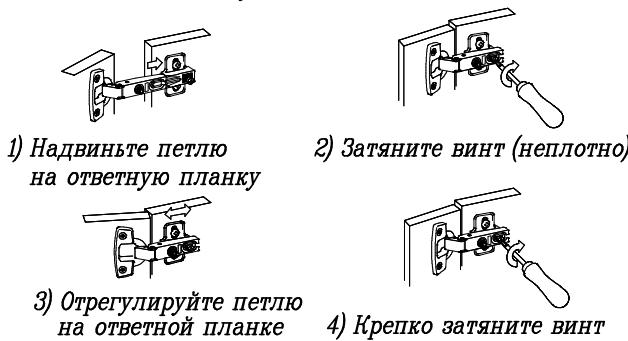
*Схема регулировки петли*
