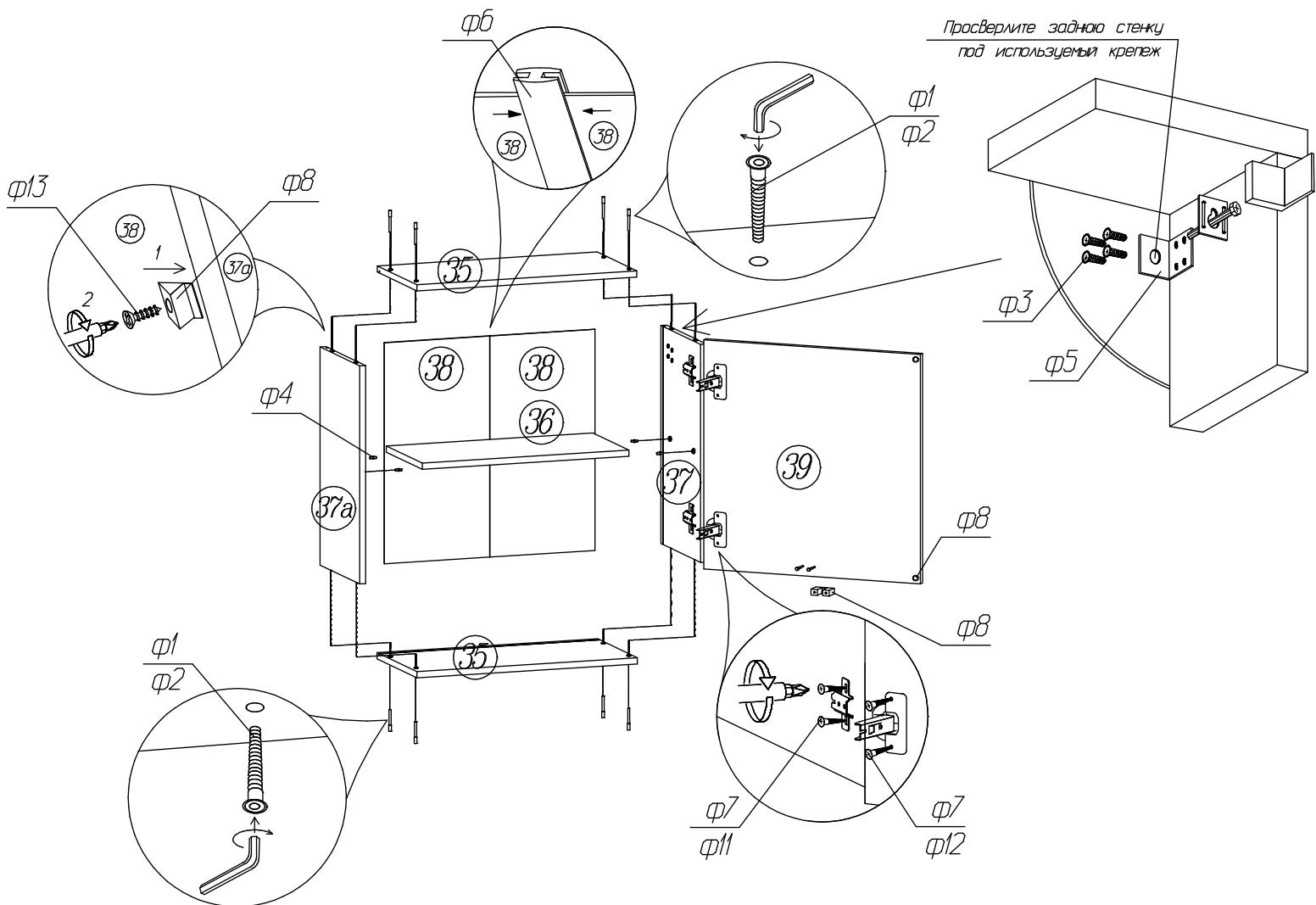
*Схема установки задней стенки шкафа
