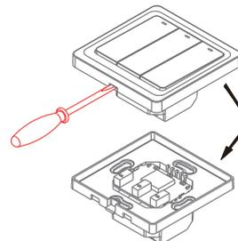
1. Аккуратно вставьте отвертку в паз передней панели устройства и снимите переднюю панель
