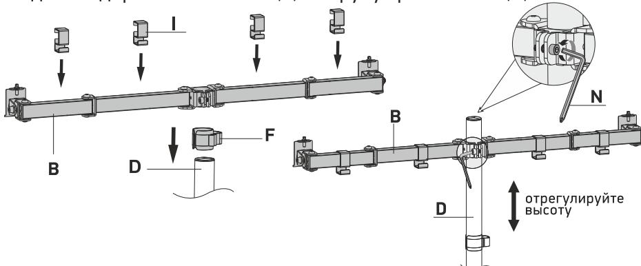
На трубу (D) установите плечо кронштейна (B). Отрегулируйте желаемую высоту и затяните винты с помощью ключа (N).
