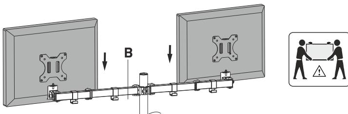
**4b.** Зафиксируйте VESA панели (A) с помощью винта (К) через проставку (J). Поверните ключом (N) по часовой стрелке, чтобы затянуть винт после установки мониторов под нужным углом. Перед регулировкой угла наклона немножко ослабьте винт.
