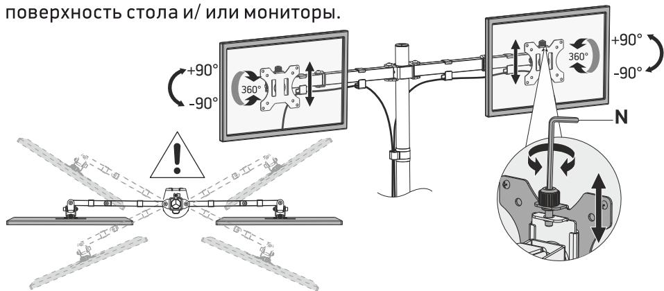
**ВАЖНО!** Затягивайте винты с усилием **НЕ БОЛЬШИМ**, чем достаточно для надежного крепления кронштейна. Чрезмерно приложенное усилие при затягивании крепежных винтов может привести к повреждению кронштейна.
