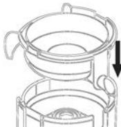
1 Вложить корпус сита в корпус устройства.
