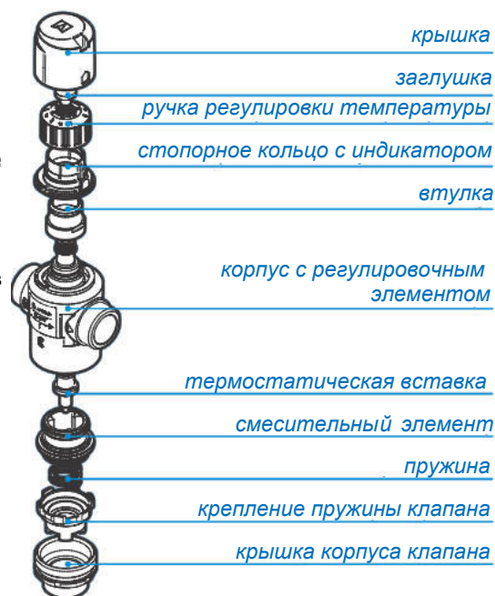
Рис. 2: Конструкция клапана ATM Kvs = 3,2 м³/ч и 4,2 м³/ч
