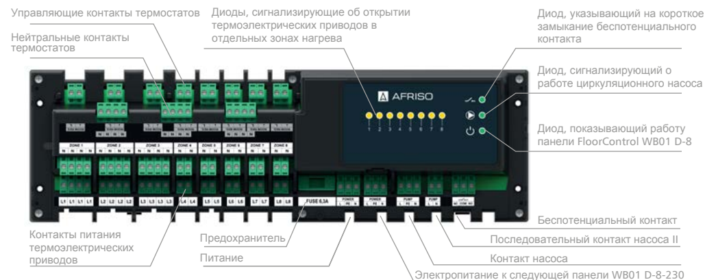
Рис. № 1. Конструкция и описание панели управления FloorControl WB01 D-8-230
